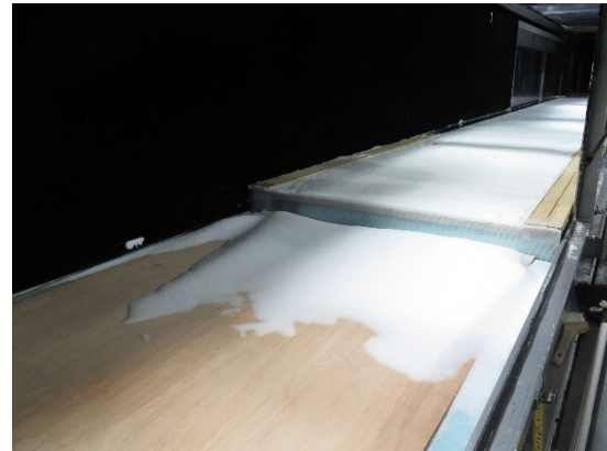
図1 風洞底面におけるステップ状の段差部分とそこに形成された吹きだまり 風洞実験による吹きだまり (風速 8 m/s, 吹雪継続時間 150 秒)
