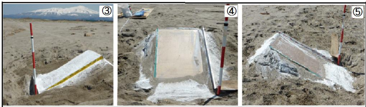
図6 砂を利用した表層雪崩の模擬実験 (ベニヤ版・90cm×60cm 勾配 \theta \approx 30^\circ 砂厚 T \approx 3\text{cm} )
