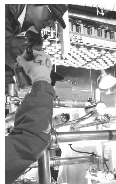
図2：湿雪から作成した疑似雪片の落下実験の様子。
