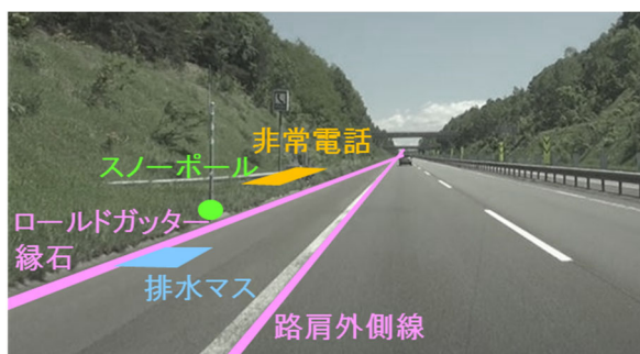
図5 高精度3次元地図の取得地物情報
