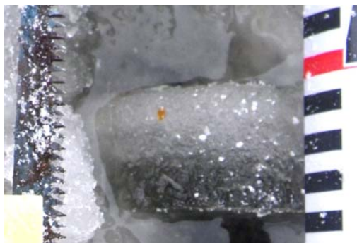
図7 この写真の中心部, 道庁の池の同心円氷紋 生成場所の池氷鉛直断面, 全氷厚さ約 3.3 cm (下 部透明氷 1.6 cm, 上部雪氷《気泡氷》1.7 cm) (2013 年 12 月 22 日 13 時 54 分)
