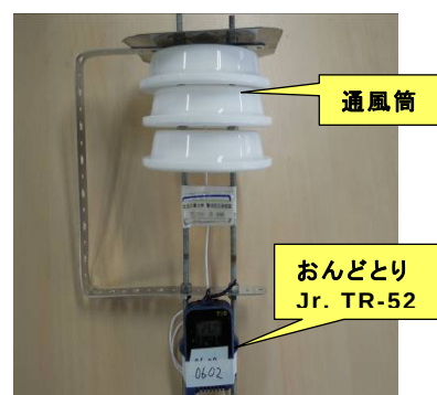
図-1 自然通風筒付き温度計
