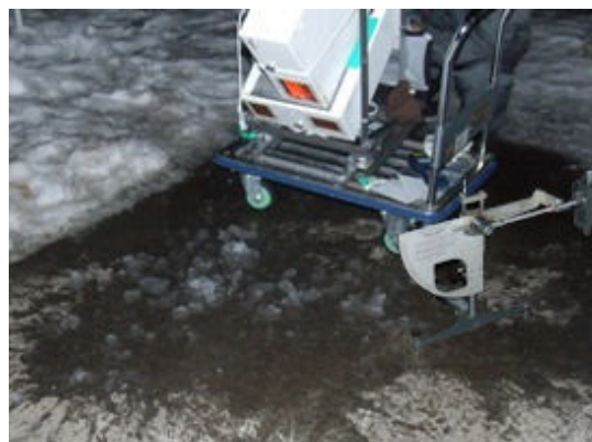
図-3 大学構内実験状況 白い箱がマイクロ波放射計（上:18GHz，下:6GHz）．右中央の装置が BPST．路面はシャーベット状態である．
