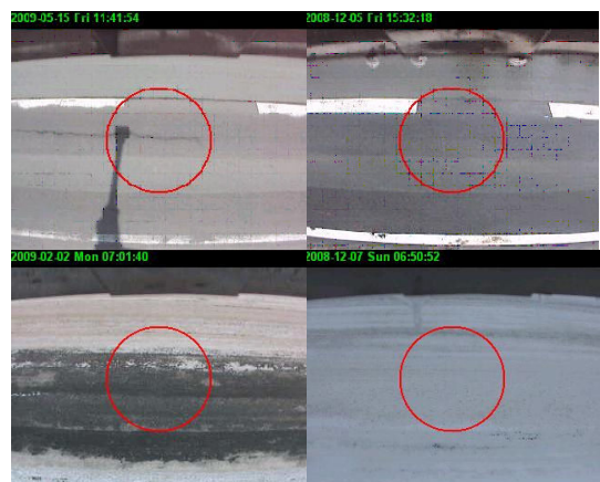
図-2 石北峠路面判別例カメラ画像
