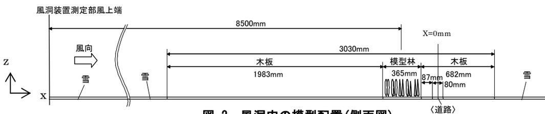
図 2 風洞内の模型配置(側面図)
