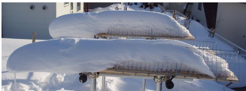
写真7 三角格子フェンスの実験状況
