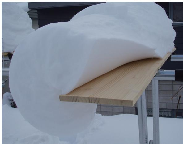
写真6 偏荷重による雪庇の剥離
