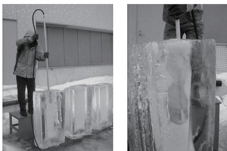
図4 氷塊 (1 × 0.5 × 0.25 m<sup>3</sup>) を用いた掘削試験
