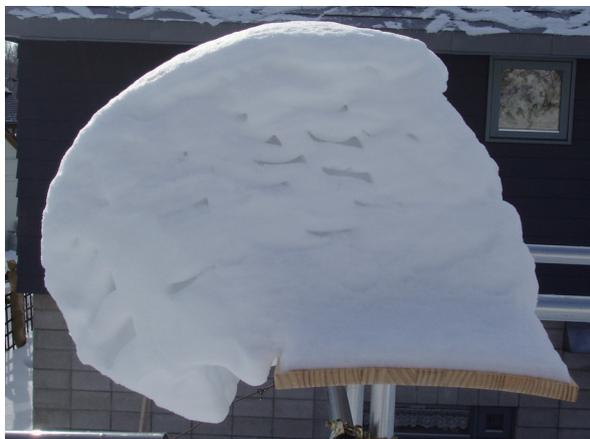
写真4 落雪前日の雪庇（36cm幅の板上）
