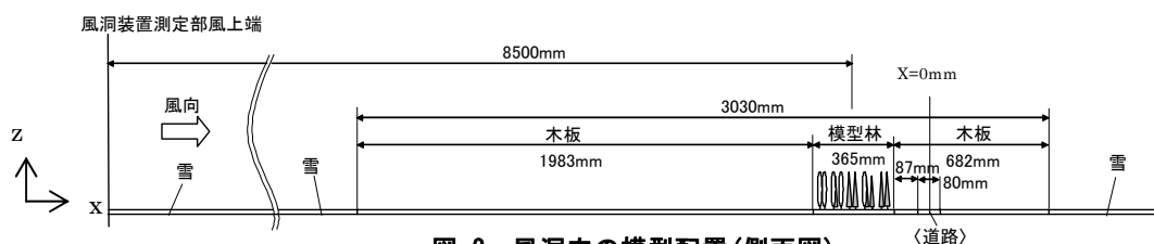
図 2 風洞内の模型配置(側面図)
